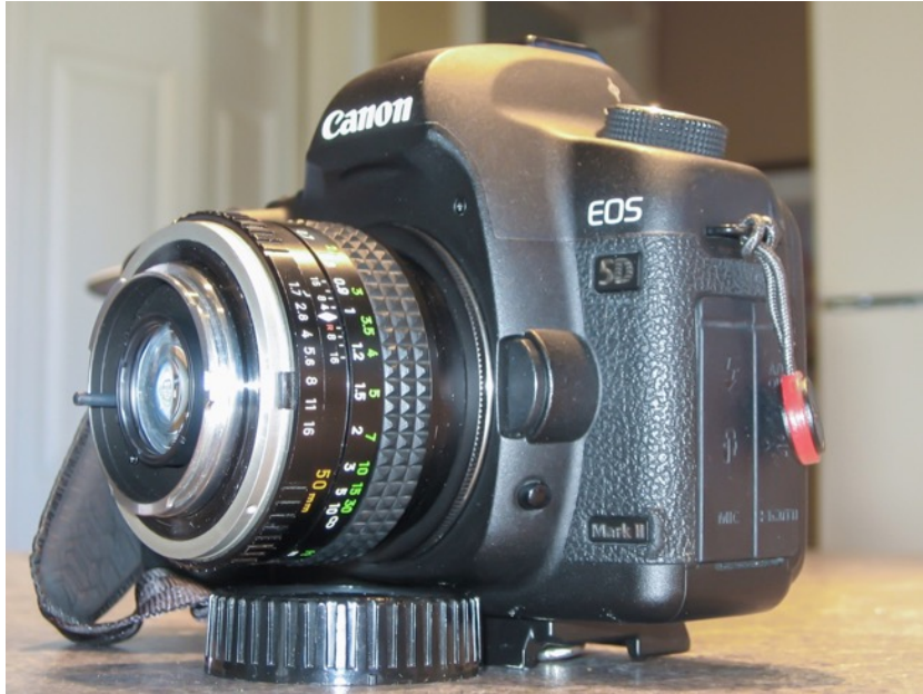
Objectif Minolta monté à l'envers sur un Canon
