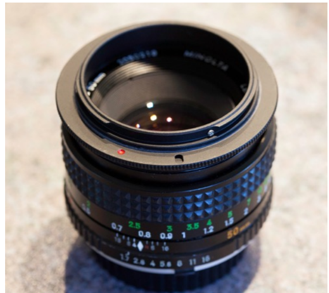
Un adaptateur avec une monture Canon et un pas de vis de 55mm. Vissé sur un objectif 50 mm f:1.7 Minolta.
